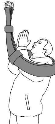
Einstieg bei geschlossener Rettungsschlinge
